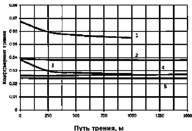
Рис. 1. Коэффициенты трения смазочных композиций: 1 – Масло М10-Г2к (Роснефть); 2 – трибопрепарат № 2 ВНИИТиН (г. Тамбов); 3 – наноалмазный состав КАРАТ-5 (г. Красноярск); 4 – состав «Evolution» С.А. Сокола (г. Пятигорск); 5 – геомодификатор МС-2 ООО «РеалИнПроект» (г. С.-Пб)
